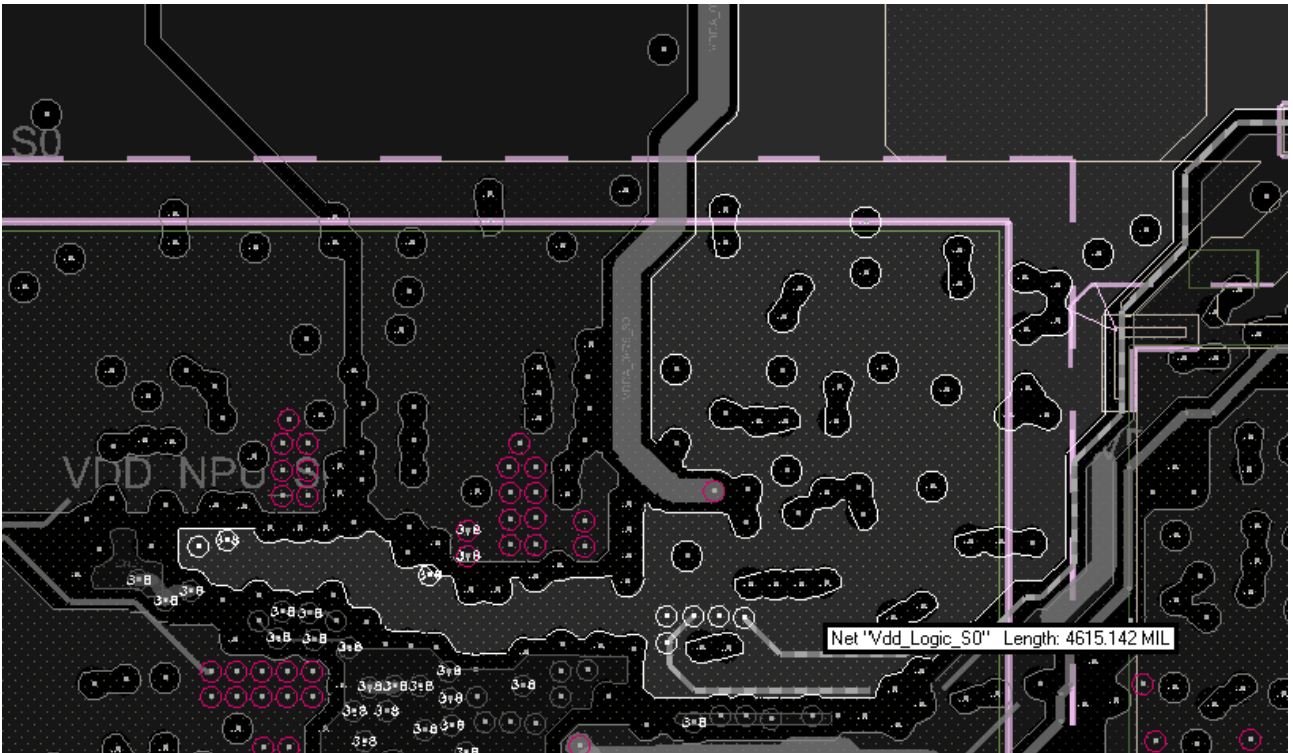
图 3-56 RK3588S 芯片 VDD_LOGIC 电源层覆铜情况
