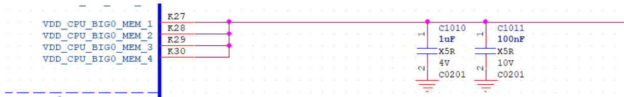
图 2-29 RK3588S 芯片 VDD_CPU_BIG0_MEM 电源
