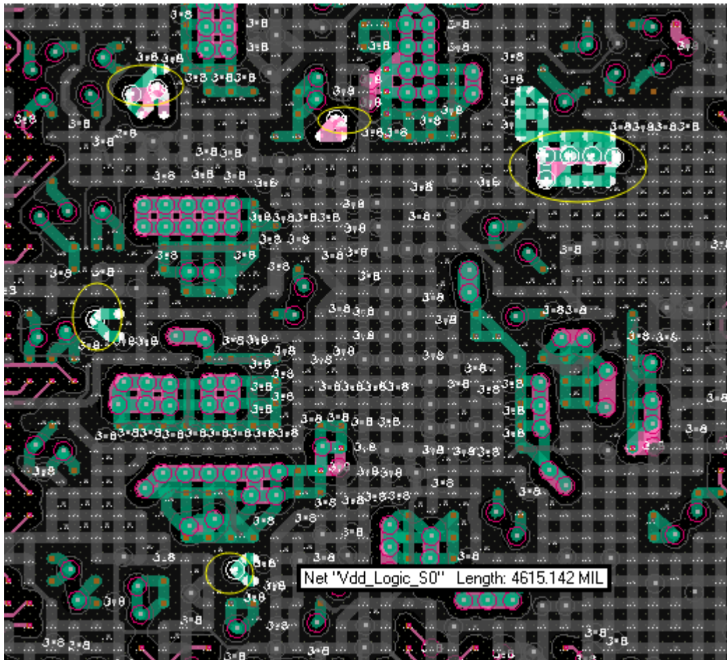
图 3-58 LOGIC 电源地过孔放置图
