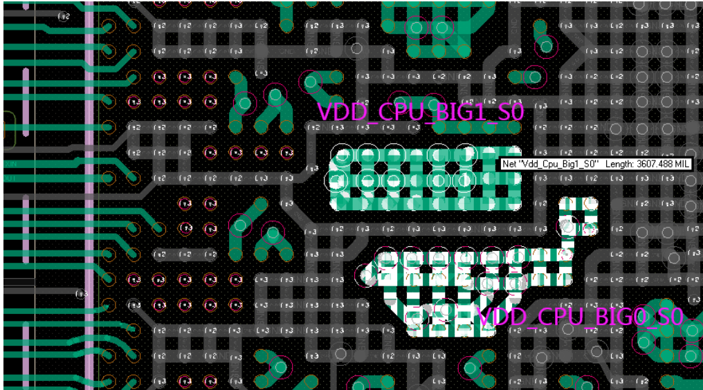
图 3-48 RK3588S 芯片 VDD_CPU_BIG0/1 的电源管脚走线和过孔
