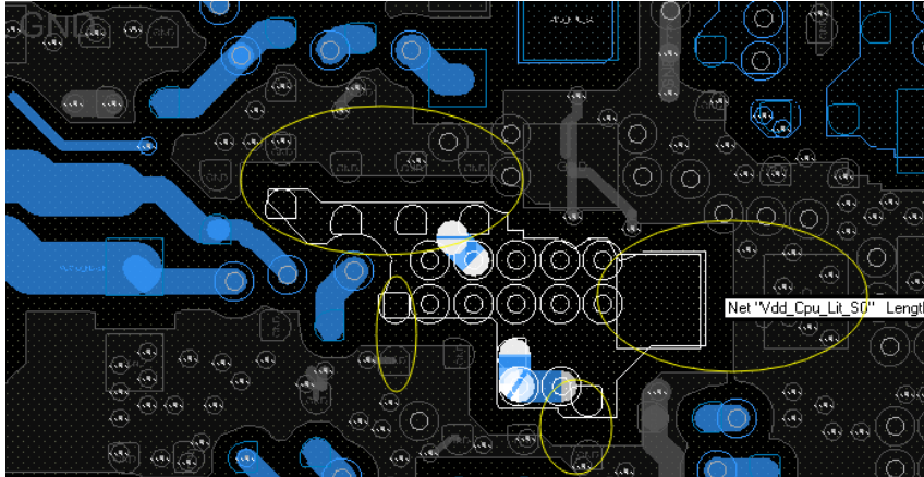
图 3-67 RK3588S 芯片 VDD_CPU_LIT 的电源管脚背面去耦电容放置情况
