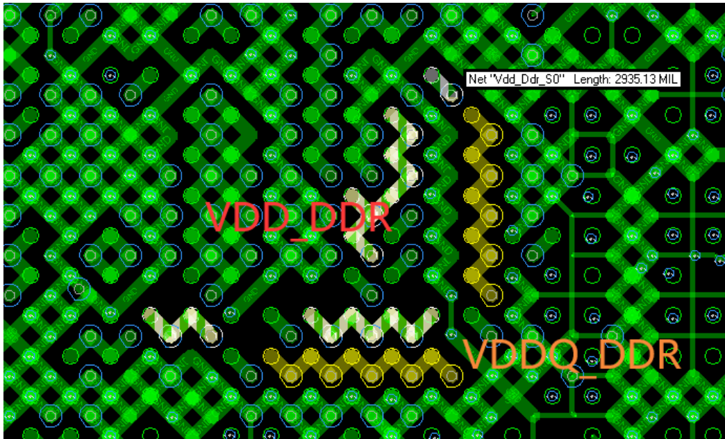
图 3-81 RK3588 芯片 VCC_DDR&VDDQ_DDR 的电源管脚走线和过孔
