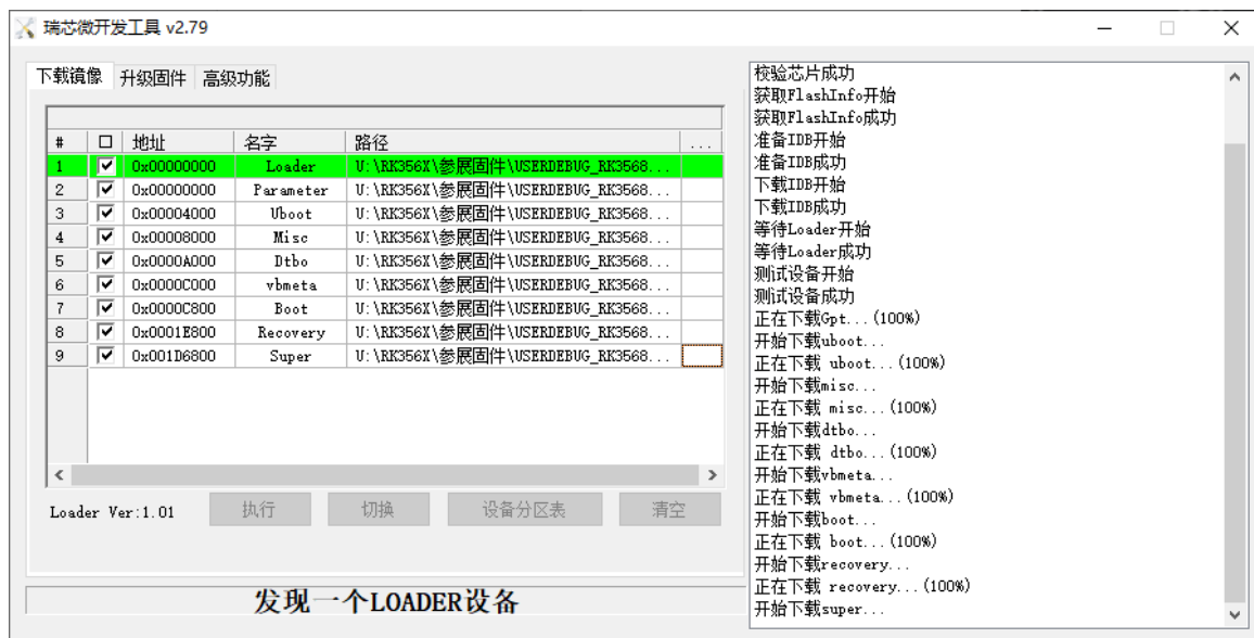
图 1-6 进入 Loader 烧写模式示意图
