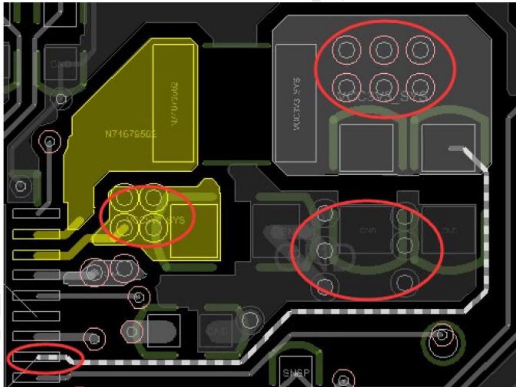
图 3 - 16 RK809-5 BUCK5布局和走线
