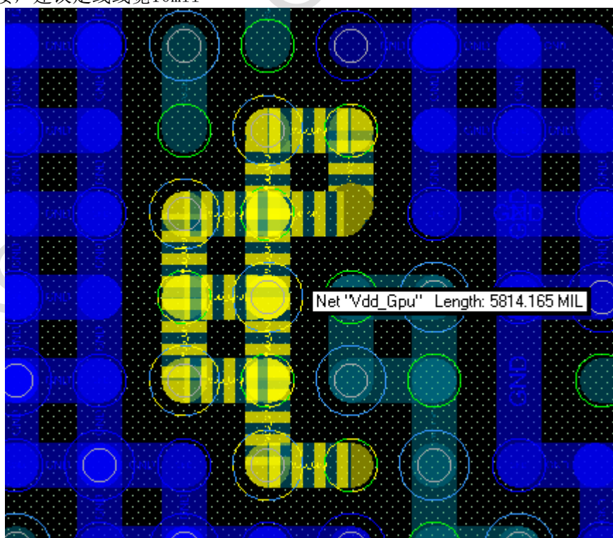
图 3 - 27 RK3568芯片VDD_GPU的电源管脚走线和过孔
