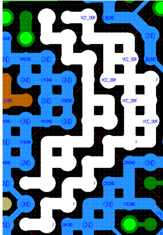
图 3 - 34 RK3568芯片LPDDR4x模式VCC_DDR/VCCOV6_DDR的电源管脚走线和过孔
