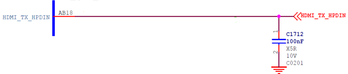
图 2 - 116 RK3568 HDMI2.0 TX PHY HPD管脚
