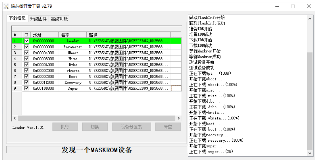
图 1-7 进入 Maskrom 烧写模式示意图
