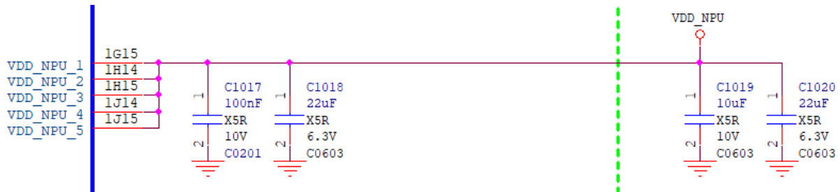
图 2-22 RK3566 芯片VDD_NPU电源及去耦
